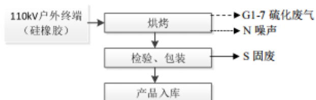
(3) 110kV 户外终端生产工艺流程图
