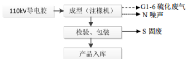
(2) 中间导电应力锥生产工艺流程图
