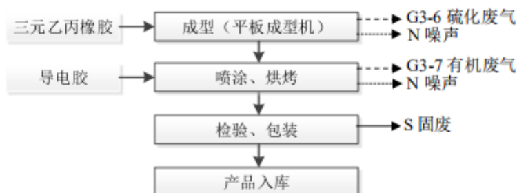
(2) 中间头生产工艺流程图
