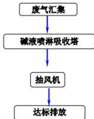
图 4-2 浸锡废气处理工艺流程图
