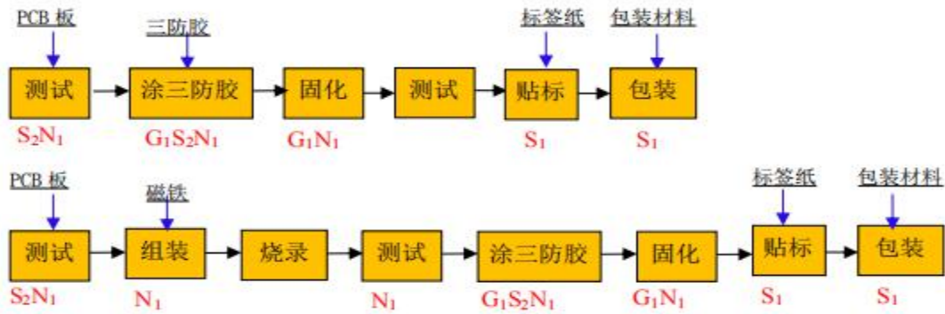
图 5-6 eRAD 逆变器的生产工艺流程及产污环节
